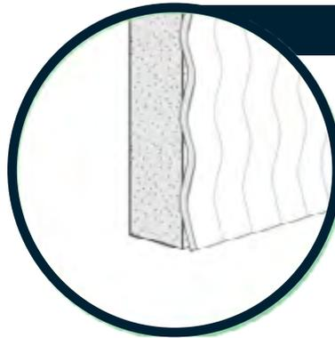
Miles de fibras incrustadas a la mezcla confieren a Tiltex® un importante refuerzo y el geotextil asegura la integridad del revestimiento.
